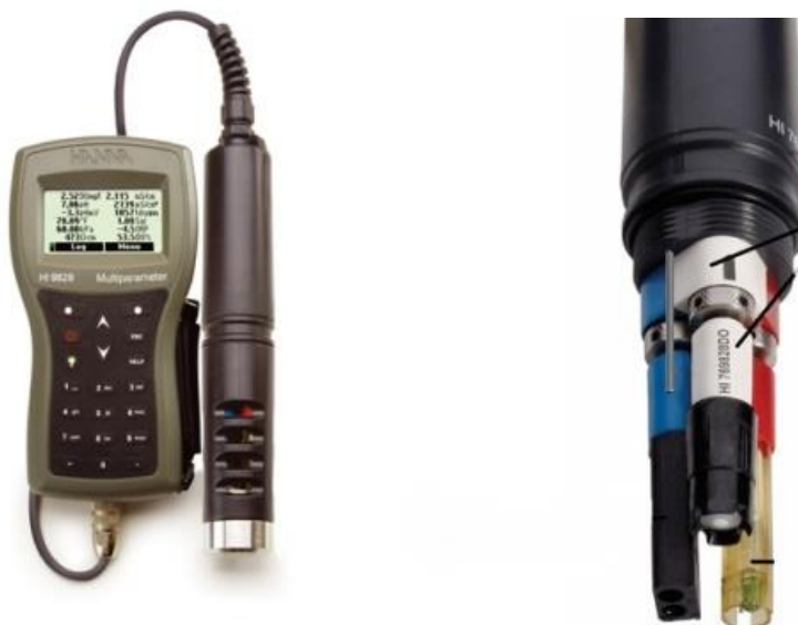
Fig. 7: Sonda multiparamétrica y sensores.
